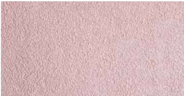
texture produite avec Ceresit CT60 plâtre acrylique, la taille des grains 1,5 mm, obtenu avec une taloche en plastique
