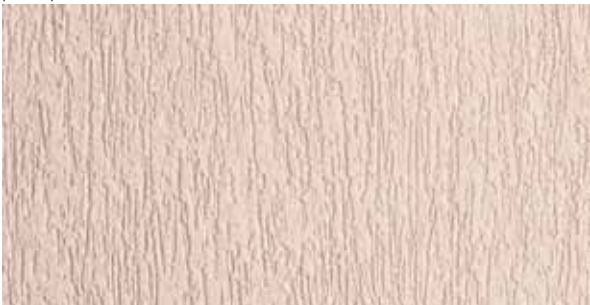
Texture rustique réalisée avec Ceresit CT35 enduit minéral, la taille des grains 2,5 mm, obtenue en faisant des mouvements dans une direction avec une taloche en plastique
