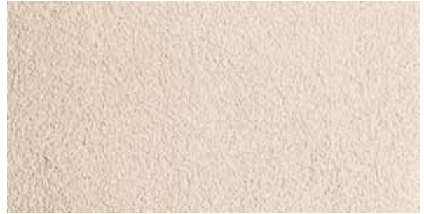
texture produite avec Ceresit CT 137 enduit minéral, la taille des grains 1,5 mm, obtenu avec une taloche en plastique
