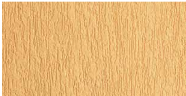
Texture rustique réalisée avec Ceresit CT64 enduit acrylique, la taille des grains 2.0 mm, obtenue en faisant des mouvements dans une direction avec une taloche en plastique
