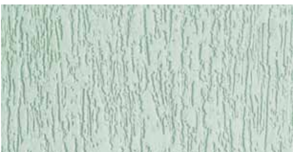
Texture rustique réalisée avec Ceresit CT63 enduit acrylique, la taille des grains 3.0 mm, obtenue en faisant des mouvements dans une direction avec une taloche en plastique
